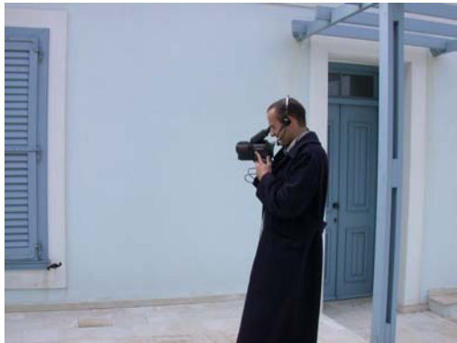
Εικόνα 2.3: Μετρήσεις με την θερμοκάμερα
