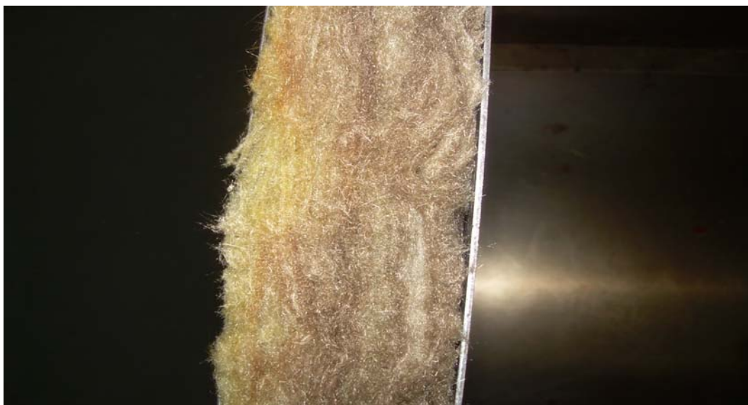
Σχήμα 4.3 Μόνωση πετροβάμβακα πάνω στο τοίχωμα του δοκιμίου
