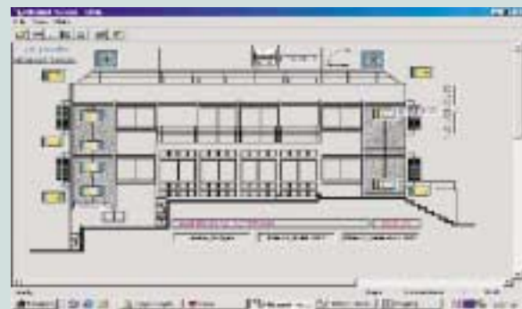
Οθόνη του συστήματος BMS, που ελέγχει την συμπεριφορά των ηλιακών συλλεκτών αέρα.
