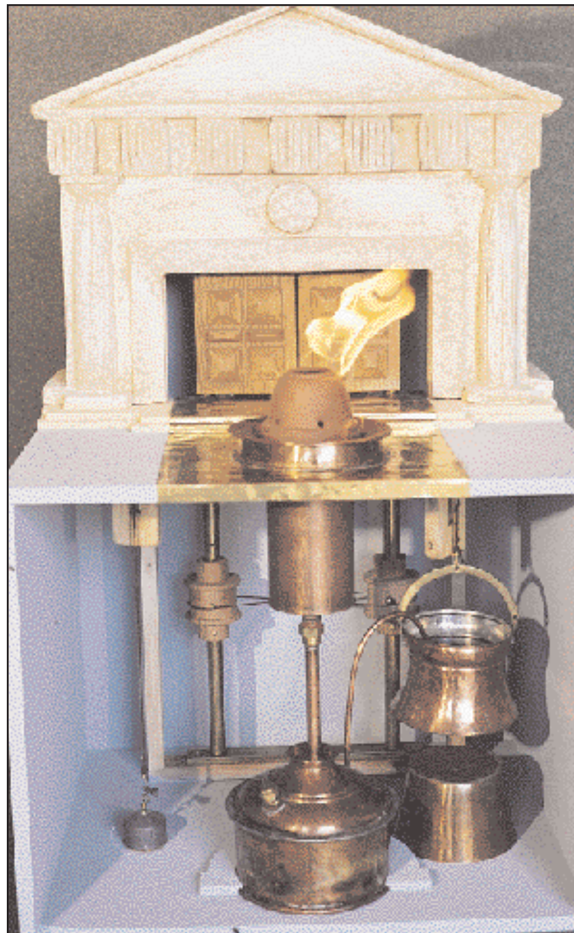
Αυτόματη κρήνη (ομοίωμα και σχέδιο, αριστερά και πάνω) και αυτόματες πύλες ναού (ομοίωμα και σχέδιο, δεξιά και κάτω). Στα αυτόματα του Ηρώνα η τεχνολογία συναντά την τέχνη.
