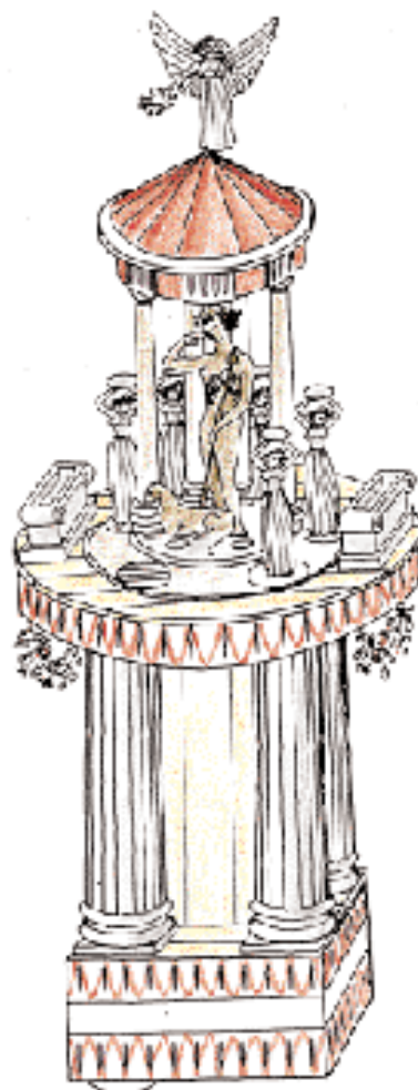
Το κινητό αυτόματο θέατρο του Ηρώνα (ομοίωμα και σχέδιο, αριστερά και πάνω). Στο κινητό αυτό είναι δυνατόν να κινούνται όλες οι μορφές, να ανάβουν διαδοχικά φωτιές σε δύο βωμούς και να ακούγονται ταυτόχρονα ήχοι τυμπάνων και κυμβάλων.
