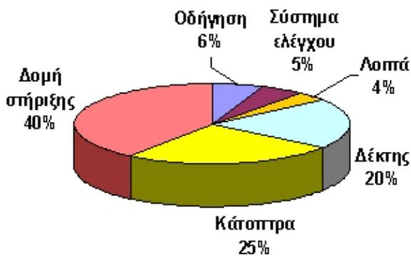
Σχήμα 4.4. Κατανομή κόστους του συστήματος συλλογής
