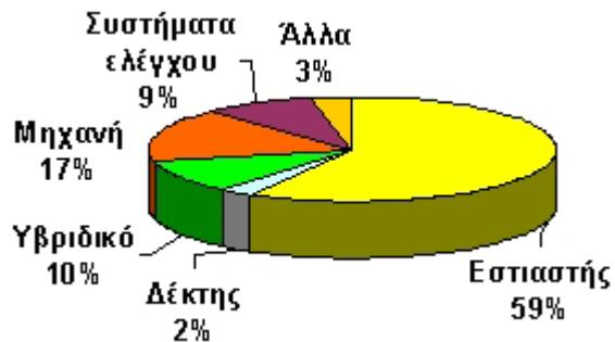
**Σχήμα 4.10. Κατανομή κόστους των συστημάτων δίσκου/μηχανής**
