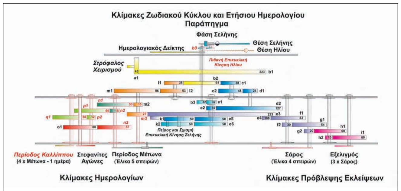
Εικ. 6. Συνολικό σχηματικό διάγραμμα της διάταξης των οδοντωτών τροχών του Μηχανισμού των Αντικυθήρων (επεξεργασία Μαγδαληνή Αναστασίου)
